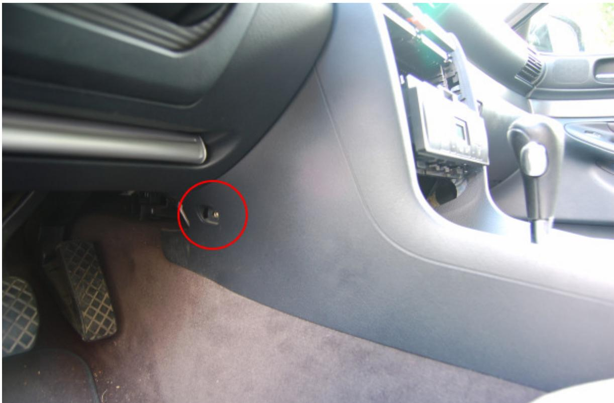
Jetzt ist die Mittelkonsole lose. Diese kann man nun vorsichtig zu sich nach vorne rauziehen. Nachdem dies geschehen ist, werden links und rechts jeweils zwei Sechskantschrauben sichtbar. Diese halten den kompletten Din-Rahmen fest (siehe Bild unten, schon ohne Rahmen). Raus schrauben, den Rahmen etwas zu sich rausziehen und alle Stecker von der Schalterleiste abklemmen.
