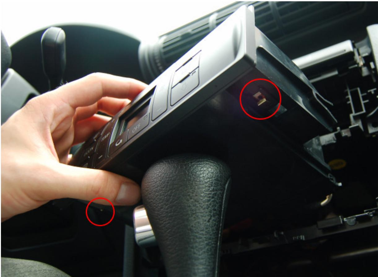
Den Aschenbecher jetzt von zwei Sechskantschrauben (links und rechts) lösen und nach vorne rausziehen. Vorsicht, hinten den Stecker für Aschenbecherbeleuchtung abklemmen.
