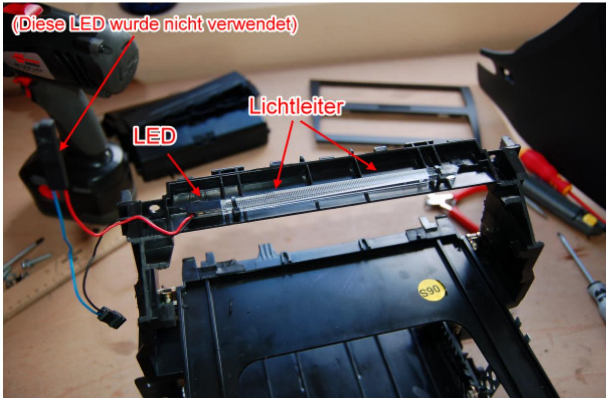
Jetzt müsst ihr gucken was ihr alles im unteren Bereich des Rahmens wegschneiden müsst damit der Rahmen in dem unteren Bereich der Mittelkonsole passt. Der Schacht für das Klimabedienteil bleibt unangetastet, nur unterhalb wie schon erwähnt müssen ein paar Plastikteile weggeschnitten werden.
